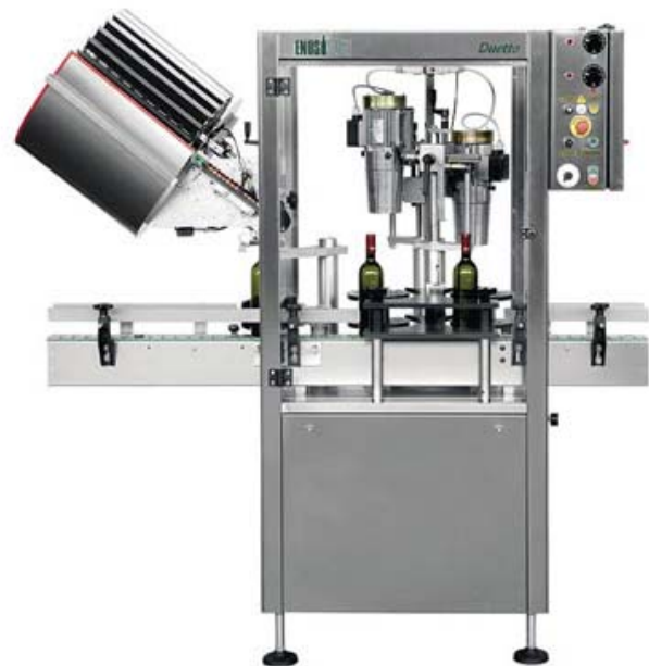
"DUETTO" con almacén para 4.000 cápsulas.
