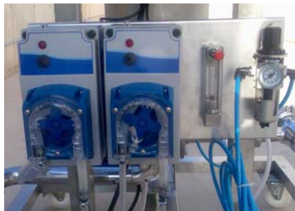
Performance FLA/PP con 2 bombas dosificadoras
